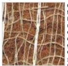
Couvertures en fibres végétales (coco, mélange paille/coco) facilitant le développement rapide du couvert végétal. Favorisent l'infiltration des eaux, limitent l'évaporation et maintiennent l'humidité. Bionattes de 350 à 500 g/m² couvrant totalement le sol, amortissant l'impact des gouttes de pluie et le choc thermique jour/nuit et accélérant la germination. Les filets supports peuvent être au nombre de 1 ou 2, naturels, synthétiques,... Plus d'info
